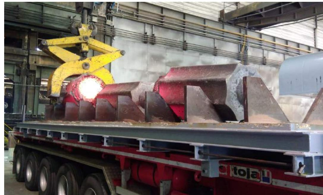
Il nostro parco mezzi dispone di semirimorchio **ribaltabile trilaterale** con sponde idrauliche adatto per il trasporto di rottame e materiali sfusi e di CASSONE TERMICO, provvisto di tutti i permessi necessari, adibito al trasporto di LINGOTTI CALDI.
